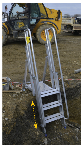
Piètements télescopiques réglables sur 4 hauteurs.
